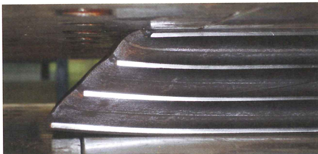
写真4-4. 下鋼板の面外変形
