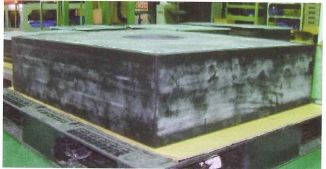
写真4-8. 性能検査後の老化防止剤の滲出
