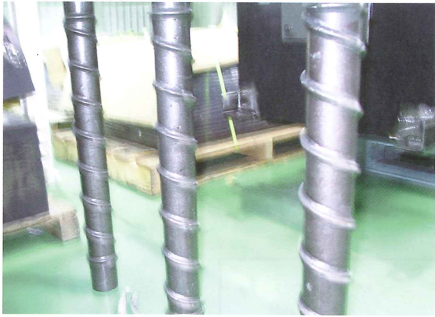
写真6-3. 異形化丸鋼アンカーボルト防せい無し
