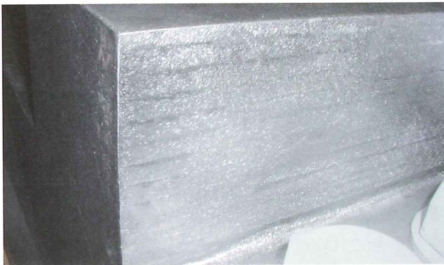
写真5-3. 鋼材切断面へのめっき
