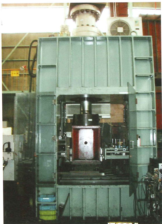
写真2-1. 疲労試験状況（全景）
