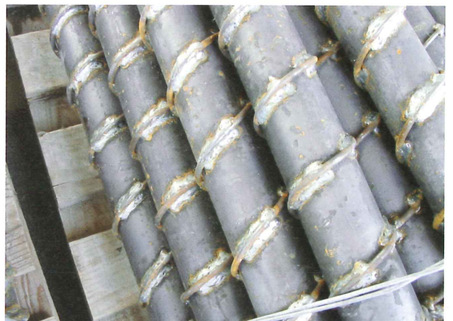
写真6-6. 細径丸鋼の千鳥溶接
