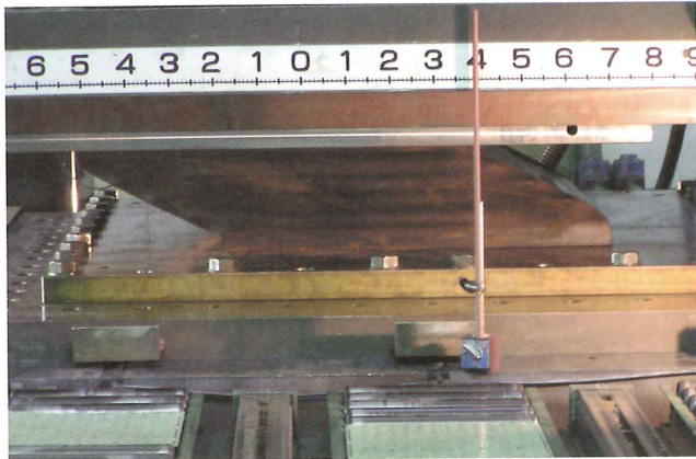
写真1-1. せん断変形250%時
