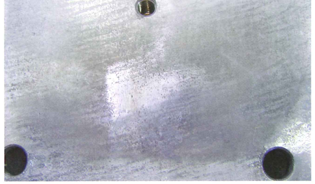
写真5-14. 加硫後のめっき面の変色（拡大）
