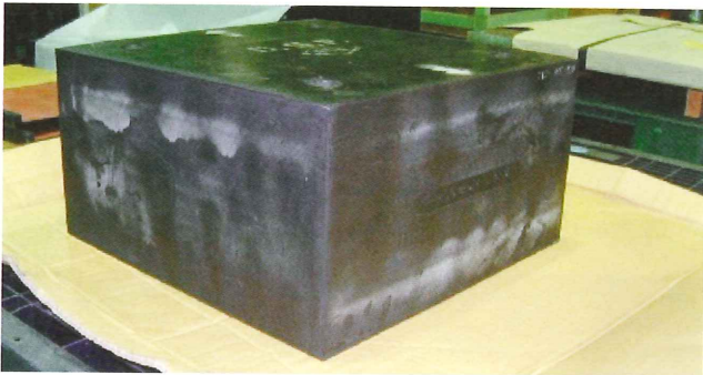
写真4-7. 性能検査後の老化防止剤の滲出
