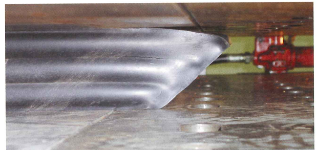
写真4-3. 上鋼板端部のまくれあがり
