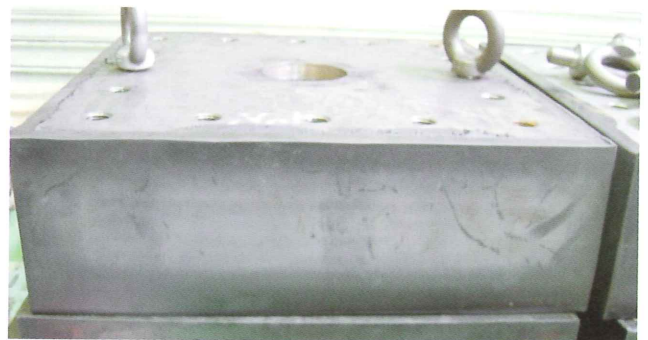
写真4-10. 性能検査後の老化防止剤の滲出
