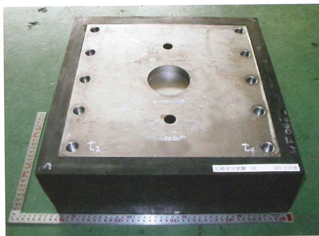
写真2-4. 200万回疲労試験後試験体 外観異常なし
