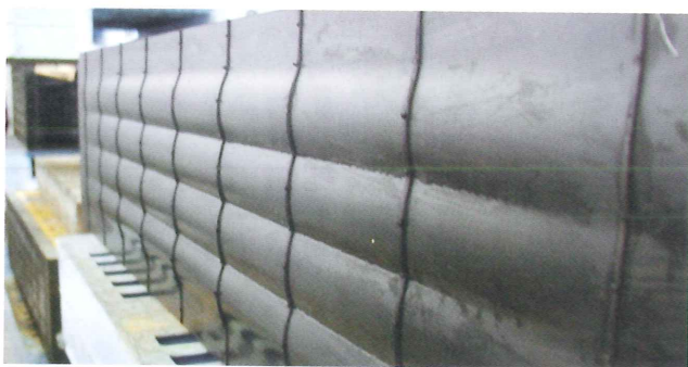
写真4-11. 試験後のふくらみおよびしわの発生
