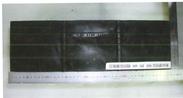
写真2-6. 200万回疲労後試験体 加振直角方向
