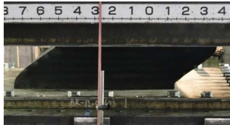
せん断試験の状況
