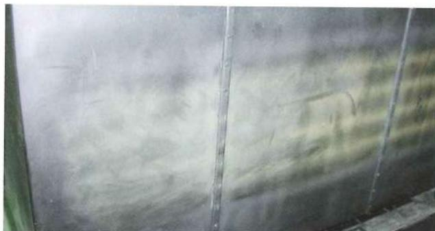
写真4-9. 性能検査後の老化防止剤の滲出
