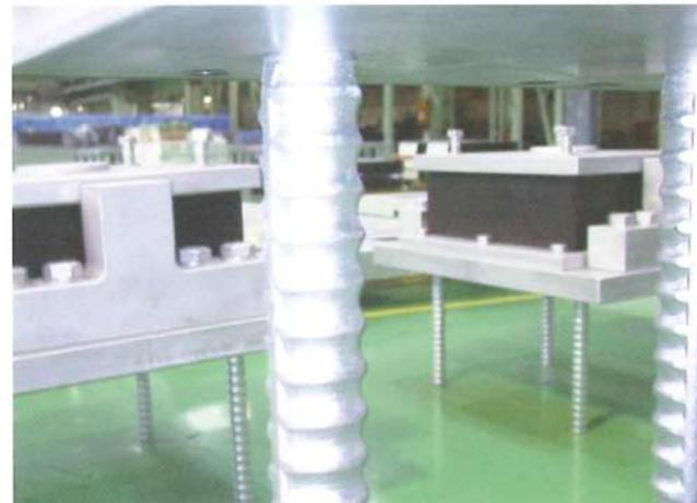
写真6-2. 異形棒鋼アンカーボルト
