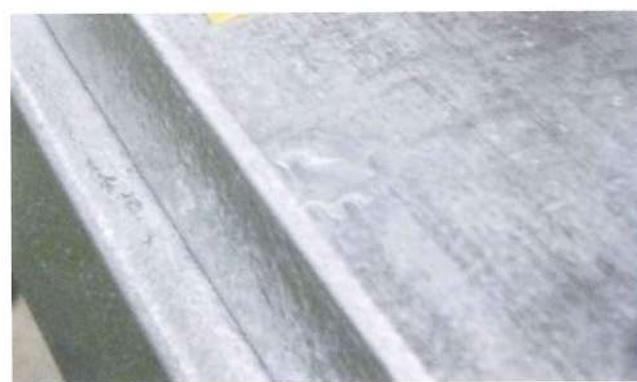
写真5-4. 鋼材の打痕へのめっき
