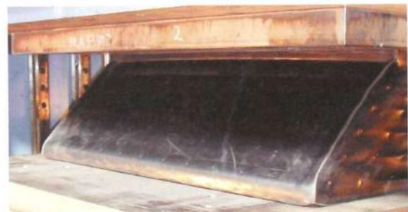
写真4-1. せん断変形時の支承端部のまくれあがり
