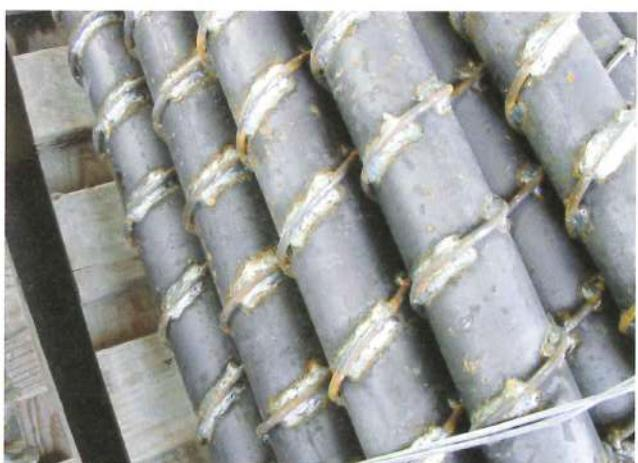
写真6-6. 細径丸鋼の千鳥溶接
