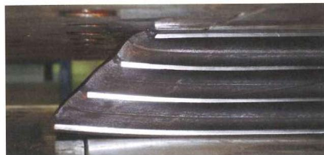
写真4-4. 下鋼板の面外変形
