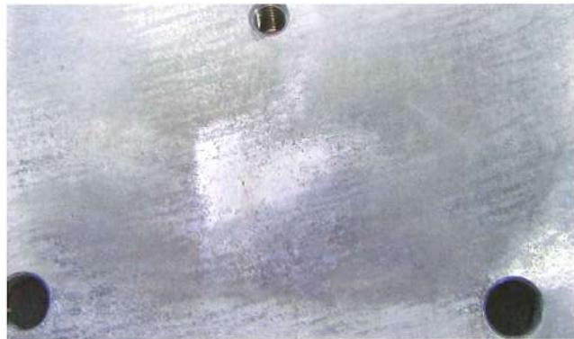
写真5-14. 加硫後のめっき面の変色（拡大）
