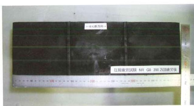
写真2-5. 200万回疲労後試験体加振方向
