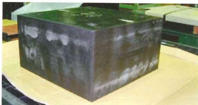
写真4-7. 性能検査後の老化防止剤の滲出
