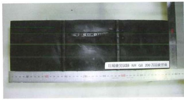
写真2-6. 200万回疲労後試験体 加振直角方向
