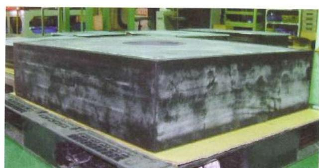
写真4-8. 性能検査後の老化防止剤の滲出
