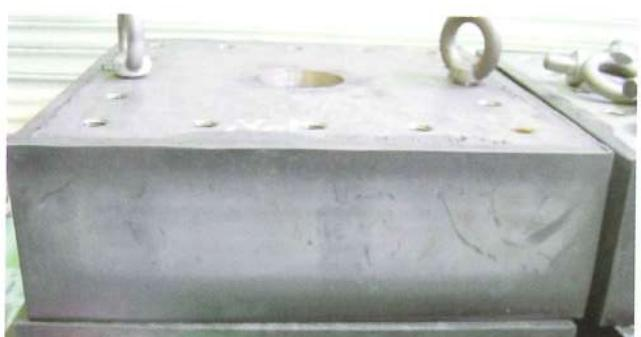
写真4-10. 性能検査後の老化防止剤の滲出
