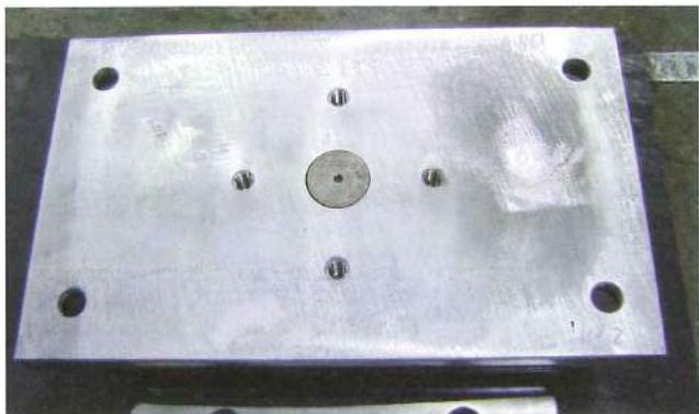
写真5-13. 加硫後のめっき面の変色
