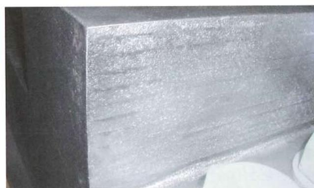
写真5-3. 鋼材切断面へのめっき
